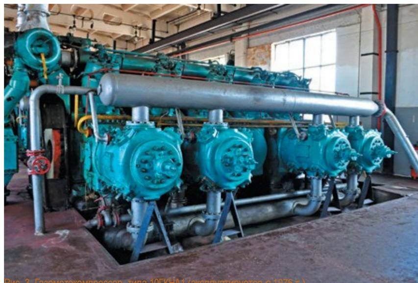
Рис. 3. Газомоторкомпрессор типа 10ГКНН1 (эксплуатируется с 1978 г.)
